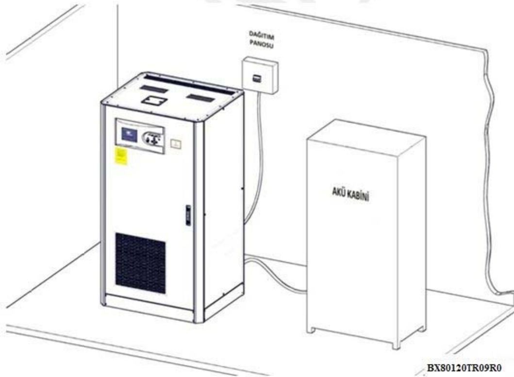
Harici Akü Kabini Uygulaması
